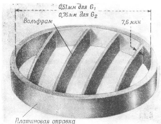
Ф и г. 13. Эскиз, иллюстрирующий конструкцию сетки, применявшуюся в окончательном варианте клистрона М1805. Вольфрамовые лопатки, встречающие электронный поток своими ребрами толщиной 7,6 мкм, располагаются широкой стороной (70 — 100 мкм) вдоль электронного потока и впаяны своими торцами в наружное платиновое кольцо. Их начальная кривизна фиксирует направление, в котором они изгибаются во время работы при повышенных температурах.
